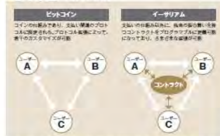
イーサリアムは「コントラクト」機能により「スマートコントラクト」を発行できる。また、高度な柔軟性を備えている。NTTデータの証券売買システム構築に活用されている。
