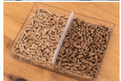
半年間寝かせて乾燥させた間伐材を粉碎した後、ペレットにして燃焼し発電が行われる。
