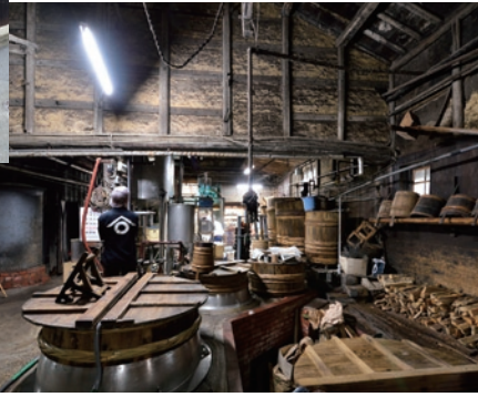
上/写真の蔵へと続く店舗に加え、「角長」では醤油造りの歴史をたどる「醤油資料館」を運営。右/大豆を蒸す釜は、手間はかかるがやさしく火が入るため薪で焚く。
