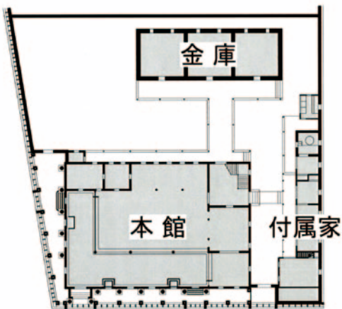
図2 新築時の広島出張所の平面図
